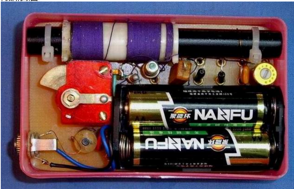
刻度盘，用药瓶盖改造，字是打印在照相纸上剪下贴上去的
