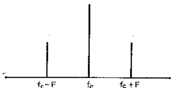
图 1·2 用单频信号调制的调幅波频谱
